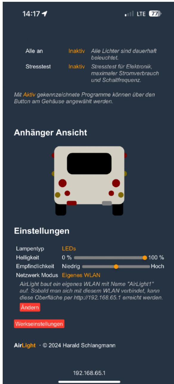
Als **Lampentyp** ist **LEDs** oder **Glühbirnen** wählbar. Die Einstellung optimiert die Beleuchtungsstärke der Lampen je nach Leuchtmittel: weder LEDs noch Glühbirnen entwickeln ihre vom Menschen wahrgenommene Helligkeit linear mit der zugeführten elektrischen Leistung. Diese Auswahl kompensiert diese Nicht-Linearität.
